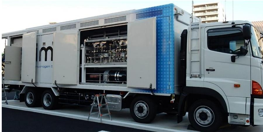
Figura 2-15: Estación de carga móvil
