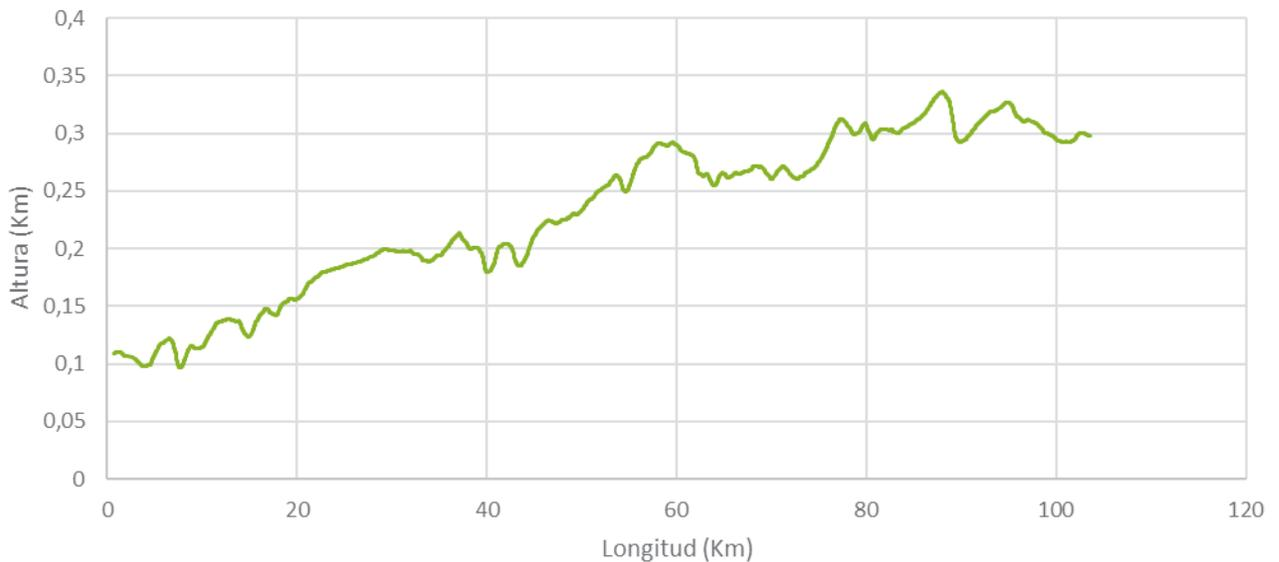
Figura 9-13: Perfil de Elevación Ruta N-59-Q (Media móvil de período 100).
